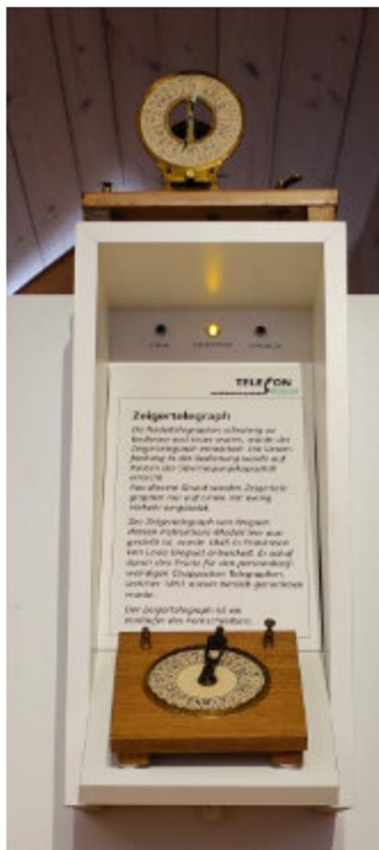
Die drei oben im Display neu verbauten LED-Anzeigen für Strom / Haltestrom / Stromlos
