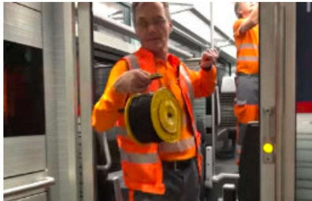
Der verdrehte Felddraht für die AWITELs wurde durch die Wagen über die gesamte Zuglänge verlegt und war 2'100 Meter lang
