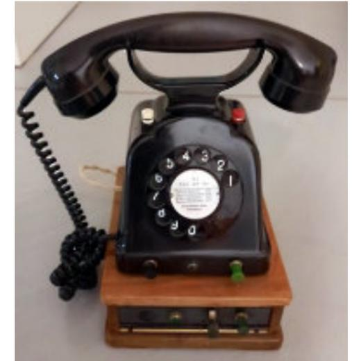
Bild 4: Linienwähler I/1 Modell 1933 mit Untersatzkasten für den Betrieb einer externen Zweigstation
